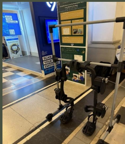
Fig. 10. Prototipul asamblat al sistemului robotic pentru asistarea mersului pediatric.
