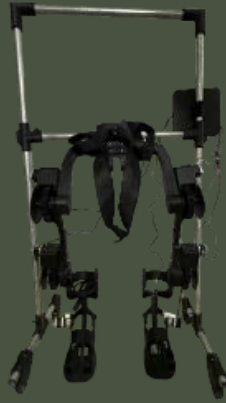
Fig. 8. Sistem robotic portabil pentru optimizarea recuperării locomotorii în paraplegia de vârstă pediatrică
