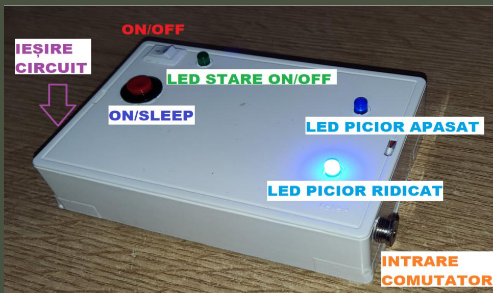
Fig. 8: Ansamblul final al dispozitivului de adaptare pentru mers
