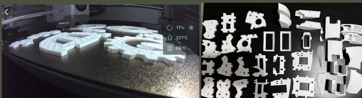
Fig. 1. Componente structurale fabricate prin printare 3D.
